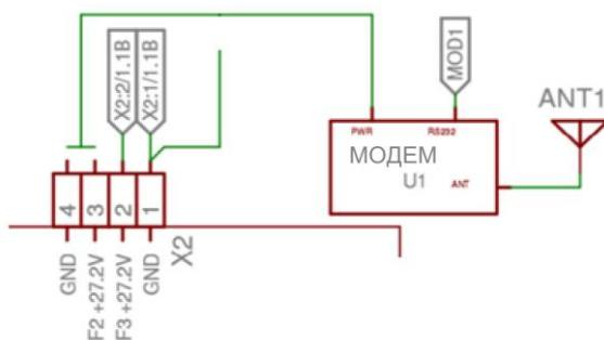
Рисунок 29 Подсоединение модема
