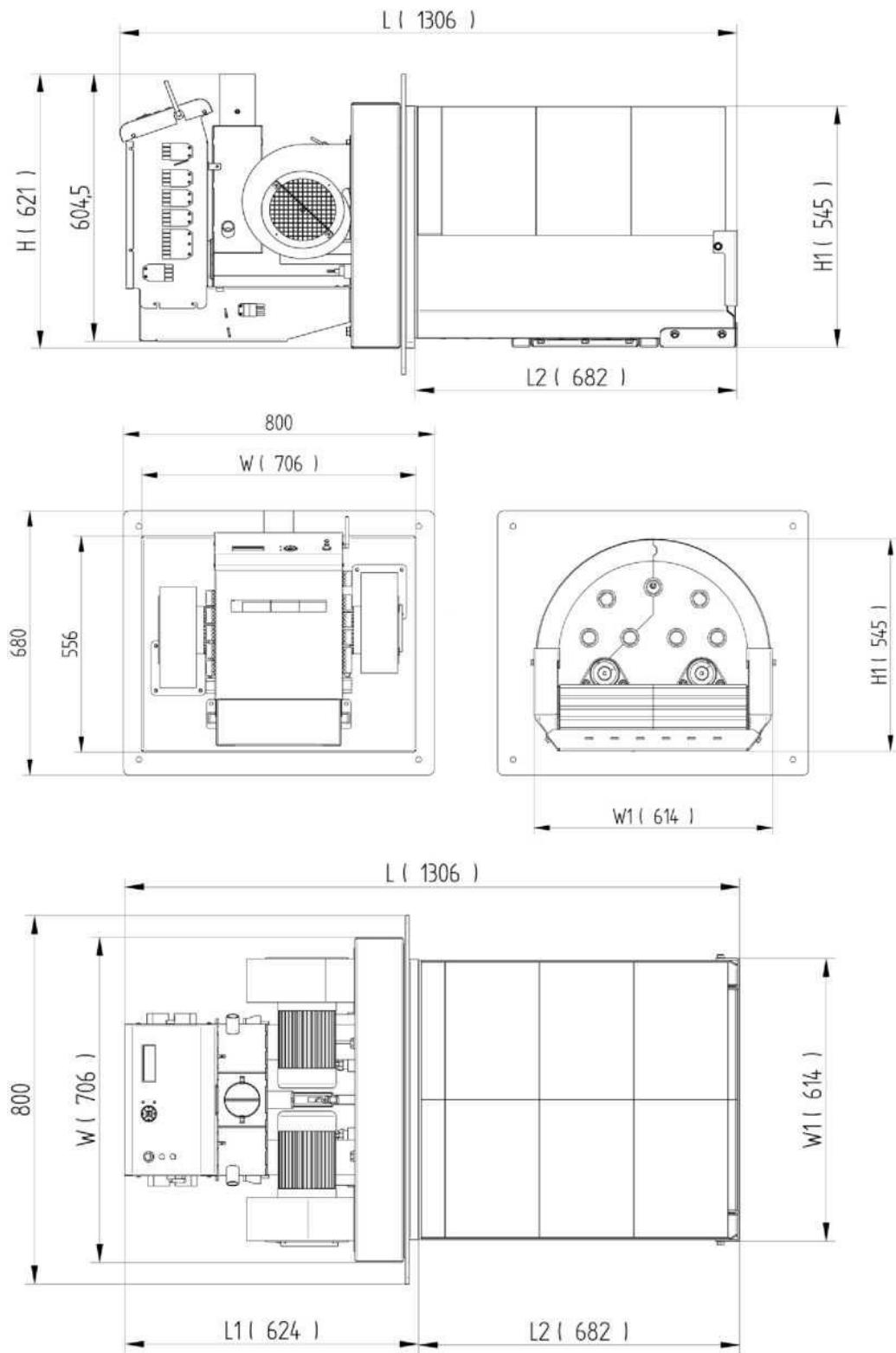
Рисунок 1 Основные параметры горелки PV1000
