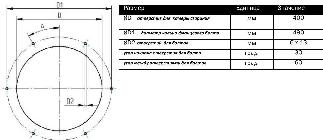
Рисунок 3. Монтажное отверстие двери котла
