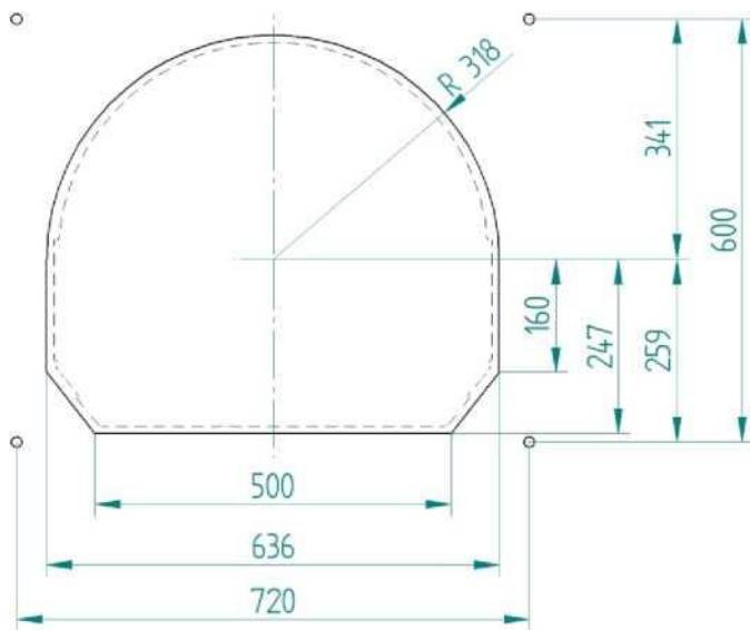
Рисунок 4 Контур резания
