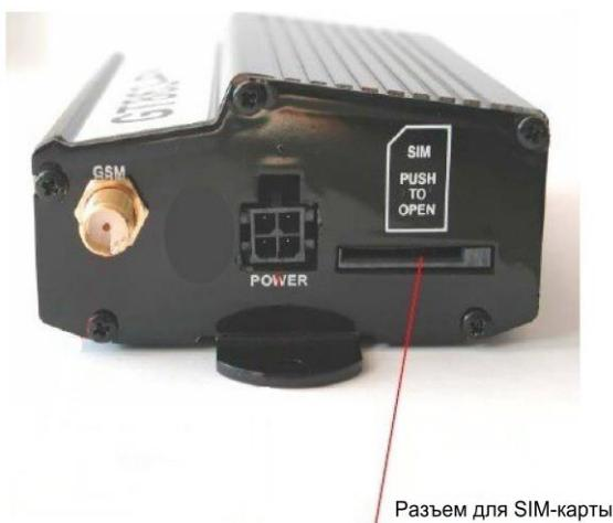
При вставке SIM карты, модем должен быть отключен от электросети. Чтобы установить карту, вставьте ее в слот до щелчка (см. рисунок 30) . Чтобы вытащить карту, нажмите ее до тех пор, пока не кликнет пружина и не выдавит ее.
