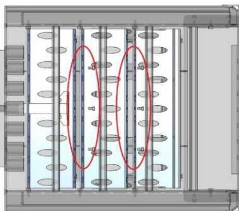
Подсоедините движущиеся решетки с помощью болтов M6x12 мм.
