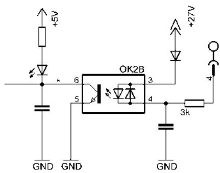
Рисунок 43. Входной контур постоянного тока
